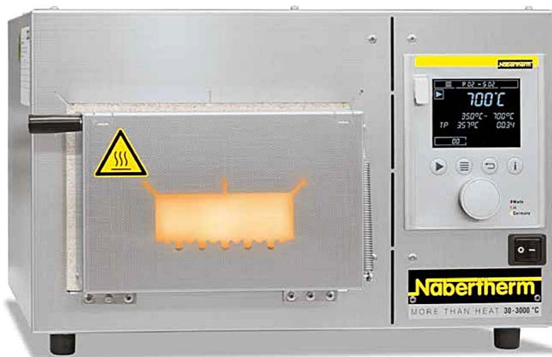
Four de recuit des perles de verre MF 5
