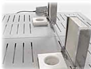
Trappe d'évacuation d'air motorisée pour un refroidissement accéléré du four après achèvement de la cuisson.
